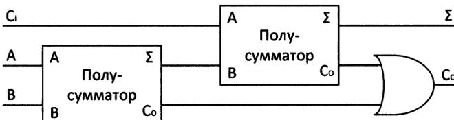
Рис. 5.2. Схема полного сумматора
